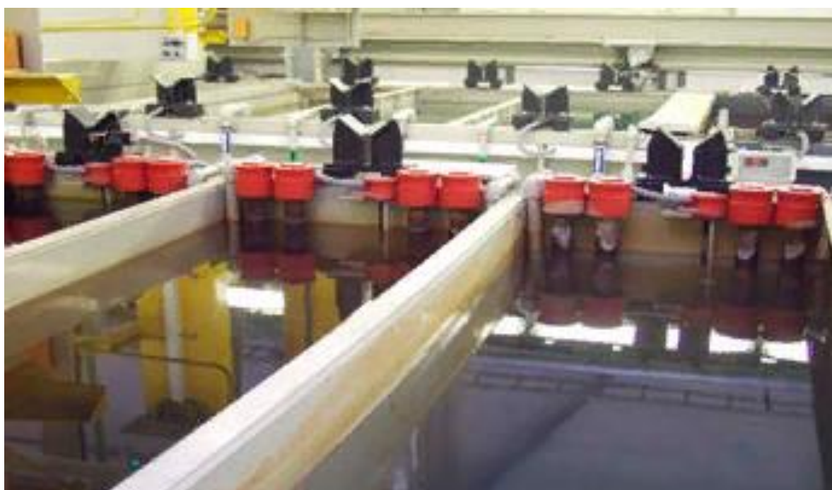
Рис. 3. Система трёхкаскадных промывок деталей
