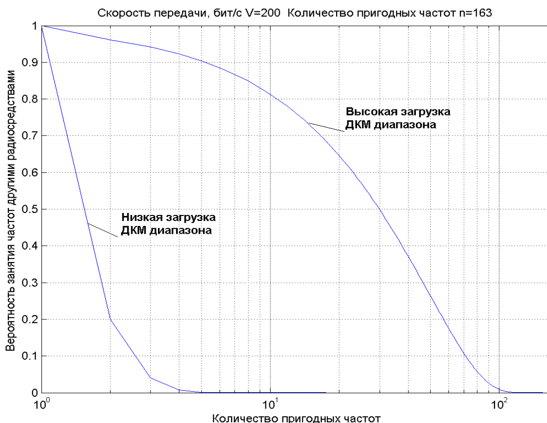
Рис. 5. Зависимость вероятности занятия частот другими радиосредствами от количества пригодных частот при скорости передачи V = 200 бит/с
