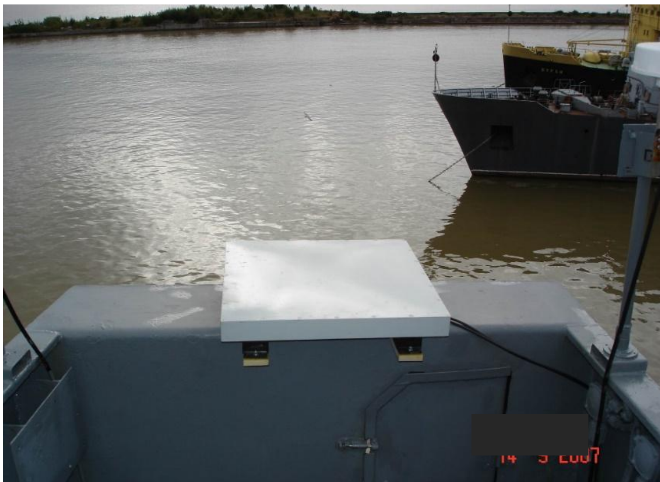
Рис. 5. Низкопрофильная широкополосная приемная антенна магнитного типа СДВ диапазона «Акция–СДВ»
